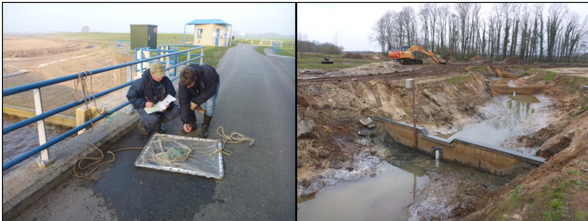
Afbeelding 4a & b: Het functioneren van de gerealiseerde vismigratie voorzieningen wordt regelmatig geëvalueerd d.m.v. verschillende technieken. Onderzoek naar glasaal bij Nieuwe Statenzijl vindt plaats m.b.v. fijnmazige kruisnetten en fuiken. Migratieonderzoek op stroomgebied niveau vindt plaats m.b.v. PIT-tags. Hiervoor worden op verschillende locaties in het beheergebied PIT antennes aangelegd waarmee getagde vissen gedetecteerd kunnen worden. Een van deze locaties bevindt zich bij de vistrap van Wedde die hier nog in aanleg is.
