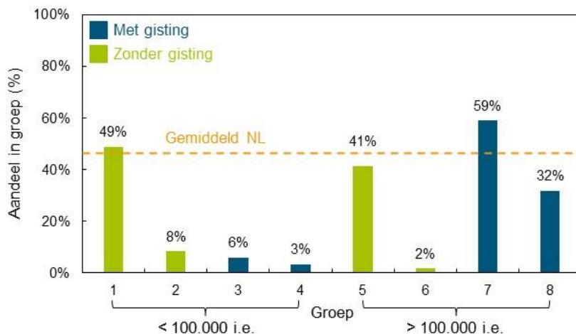
Figuur 5 Vertegenwoordiging van de aanwezigheid van een gisting in elk van de onderzochte groepen. De even groepen (2,4,6 en 8) zijn de groepen die de zuiveringen bevatten met een risico op hoge lachgasemissies. De oneven groepen bevatten de zuiveringen met een gemiddeld risico op lachgas.
