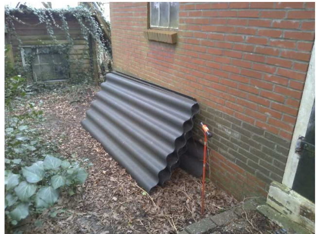
4. niet asbesthoudende golfplaten tegen de zuidwestelijke muur van de woning (vanuit het zuiden)
