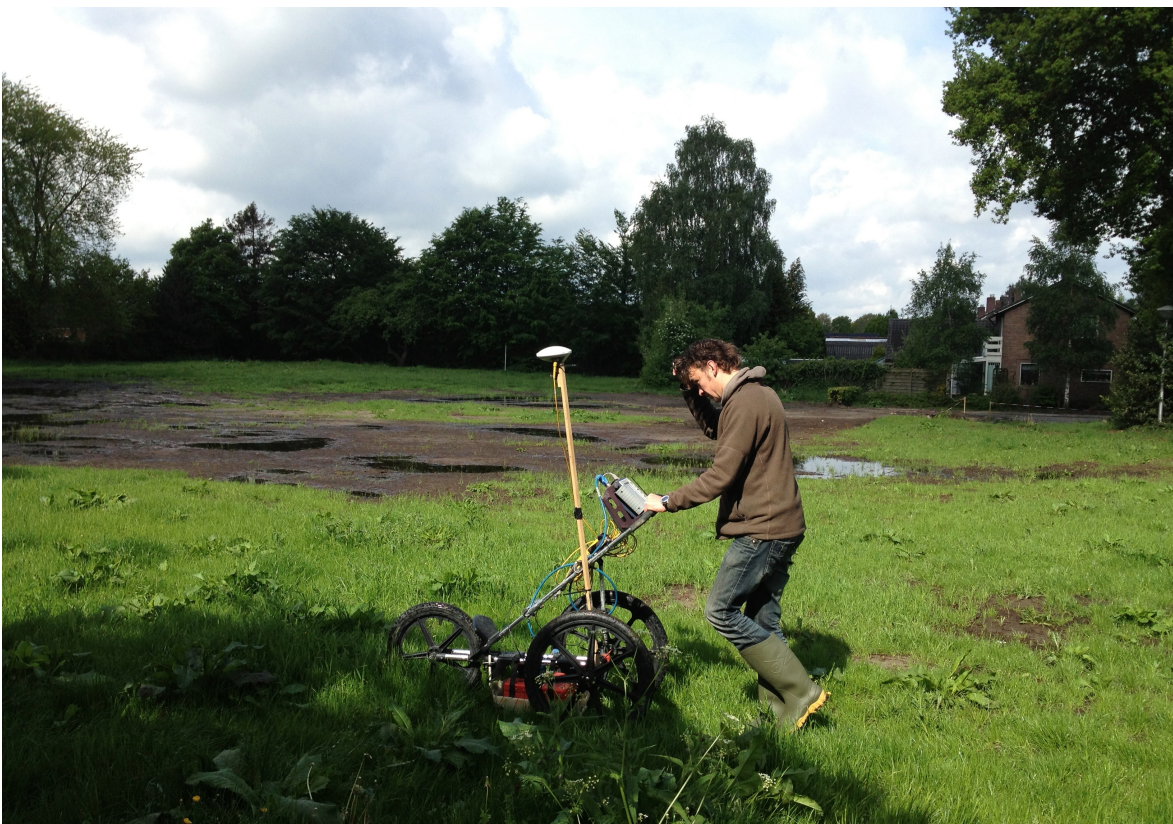
Figuur 2: Met een grondradar in een karretje kan ook worden gelopen over kleine percelen.
