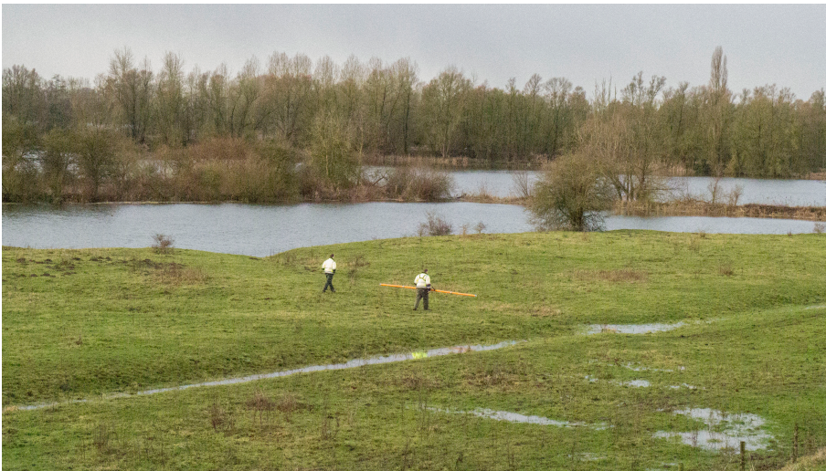
Figuur 5: Met een EM systeem (de oranje buis) wordt vaak lopend gemeten.
