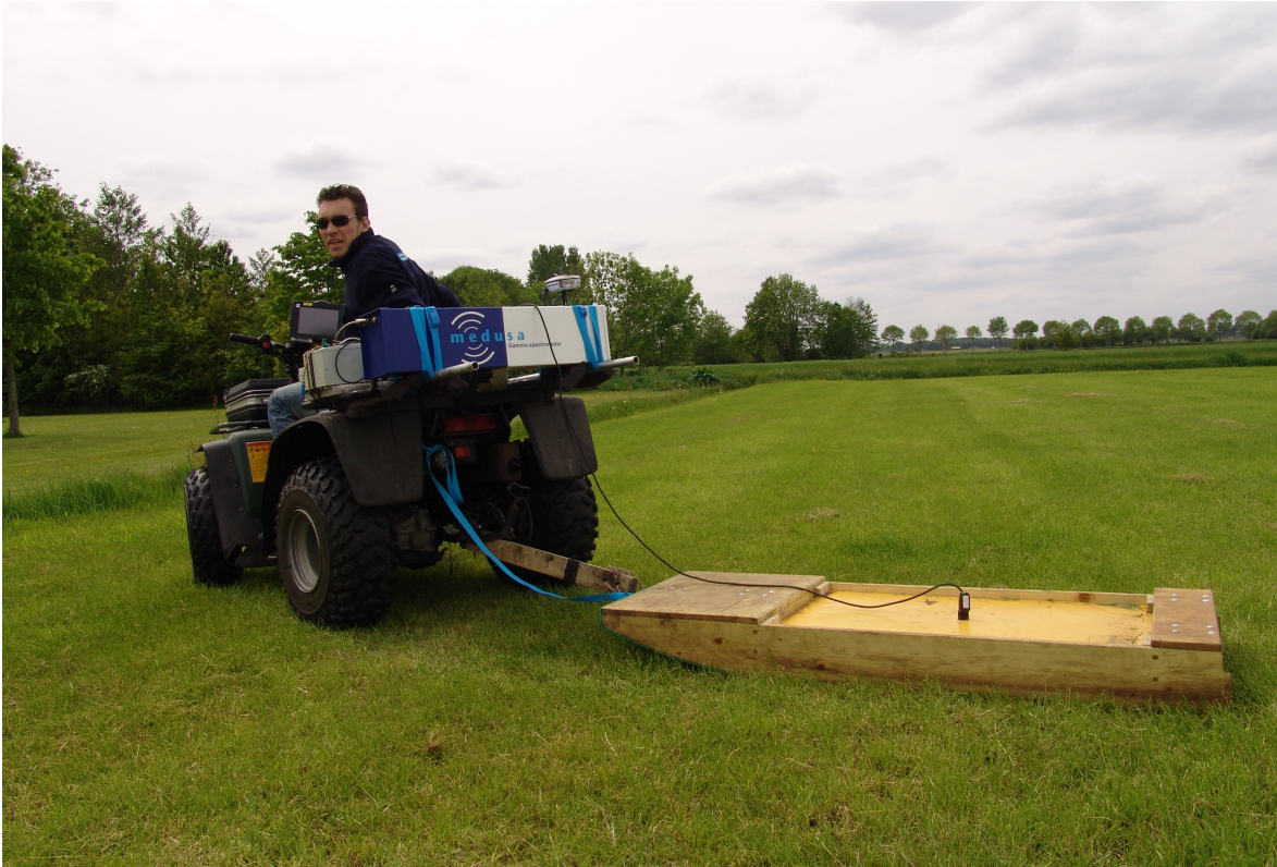
Figuur 1: een grondradar (gele doos in slede) kan achter een quad over een perceel heen worden gereden. De blauw-witte buis achterop de quad is een gammaspectrometer.
