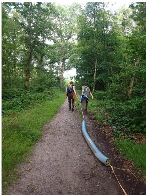
Figuur 5 impressie van de meetopstelling en meting met de gammaspectrometer die op de bodem ligt en wordt voortgesleept in het Anloërdiepje
