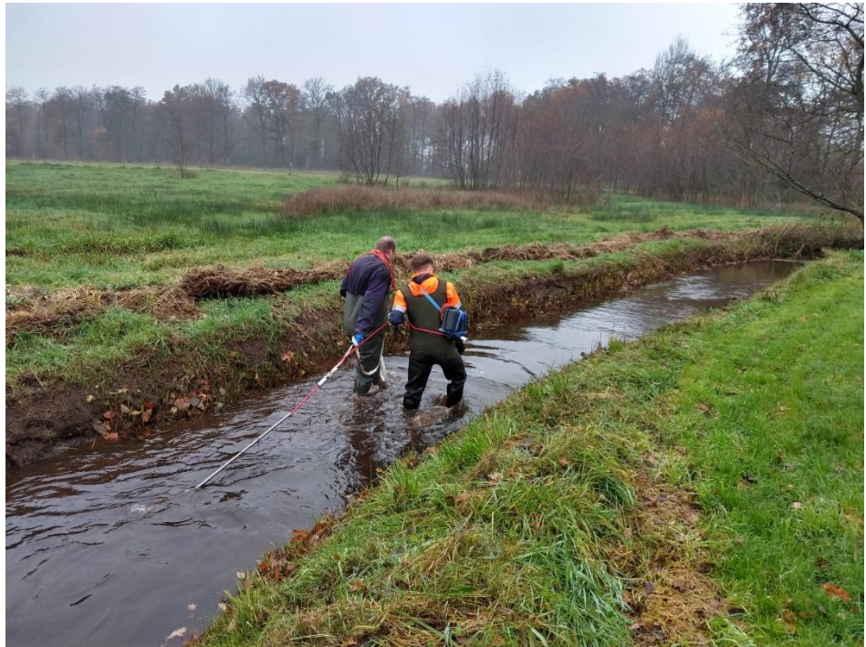
Figuur 4 impressie van de metingen met de gammaspectrometer die op de bodem ligt en wordt voortgesleept in het Zeegserloopje .
