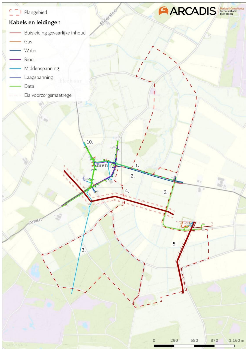
Figuur 12: Aanwezige kabels en leidingen Amerdiep
