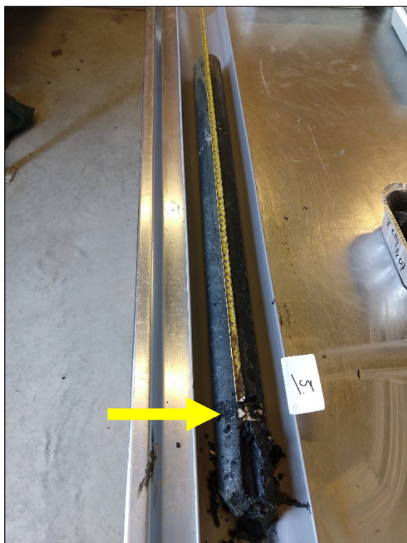
Figuur 3.2 Ingevroren boorkern uit de Klutenplas gestoken op 8 september 2020 in kaolienveldje nr. 5. De gele pijl geeft de positie aan van de gedeeltelijk uitgerepareerde markeerhorizont van kaolienklei die de grens markeert tussen de oorspronkelijke bodem van de Klutenplas en het nieuw afgezette slib na de aansluiting van de plas op de Dollard.
