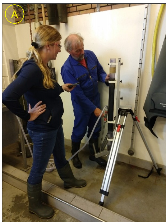
Figuur 3.3 (A) Opstelling van het los- en verdeelsysteem van de Beekersampler waarmee een boorkern in 9-centimeter hoge deelmonsters kan worden gesplitst. Op de foto is met een rubberen manchet een 10-cm hoog buisje aangesloten op de bemonsteringsbuis om het eerste deelmonster op te vangen. (B) Met een afdopspatel wordt het deelmonster gescheiden van de boorkern.
