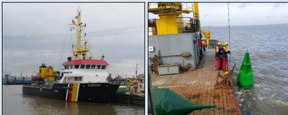
Afbeelding 5.2.a&b. Met het betonningsvaartuig Norden van het Wasser und Schifffahrt Amt (WSA) zijn de ontvangers bevestigd aan boeien in de Eems.
