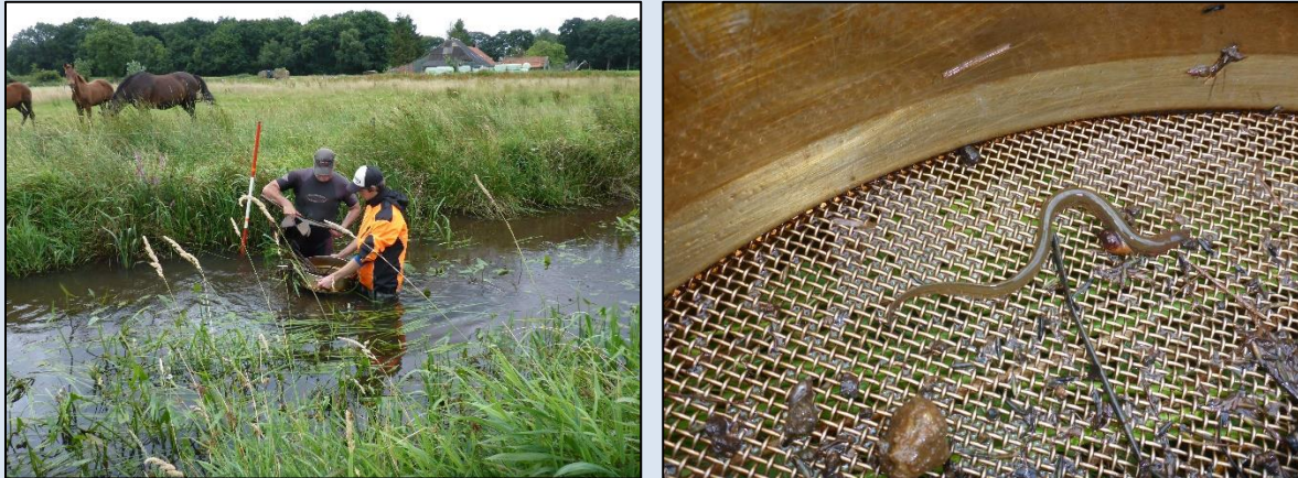
Afbeelding 5.8 a&b. Uitvoering van bodemsubstraat onderzoek in de Ruiten Aa met behulp van een bodemhapper en zeef. Hierbij is onder andere jonge paling aangetroffen in de Ruiten Aa.
