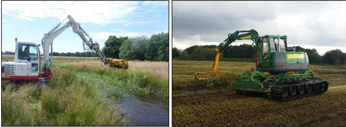
Afbeelding 5.11 a&b. Een deel van de Ruiten Aa wordt momenteel onderhouden met behulp van een lichte kraan met verlengde giek (a). In natte beekherstelprojecten is een dergelijke kraan niet overal goed toepasbaar zonder insporing te veroorzaken, zodat daar wordt bekeken of een lichte kraan op het onderstel van een rupsmaaier (b) in zeer natte terreinen een mogelijk alternatief is.
