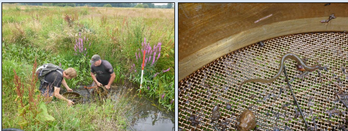
Afbeeldingen 4.3. a & b: Uitvoering van bodemsubstraat onderzoek in de Mussel Aa met behulp van een bodemhapper en zeef. Hierbij is onder andere jonge paling aangetroffen in de Mussel Aa.
