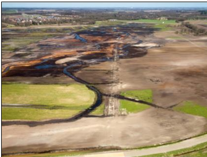
Afbeelding 6.3. Projectgebied Mandelanden direct na de ontgraving. De rode kleur van de bodem duidt op de aanwezigheid van veel ijzer in de bodem. Naast de kronkelende beeklopen is ook de gedempte genormaliseerde loop als rechte lijn in Noord-Zuid richting duidelijk zichtbaar op de foto.
