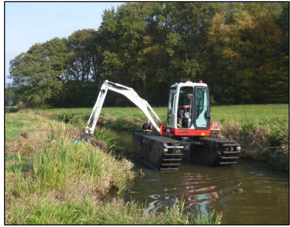
Afbeelding 7.8.a&b. Een deel van de Drentsche Aa wordt momenteel onderhouden met behulp van een maaiboot (a). Deze veroorzaakt met de voortstuwingschroeven veel opwerveling en verstoring van de waterbodem. Het waterschap onderzoekt nu of een lichte amfibische kraan (b) die rustig door het water kan rijden een mogelijk alternatief is die de waterbodem minder verstoort voor beektrajecten waar beheer met behulp van regulier materieel vanaf de kant niet mogelijk is.
