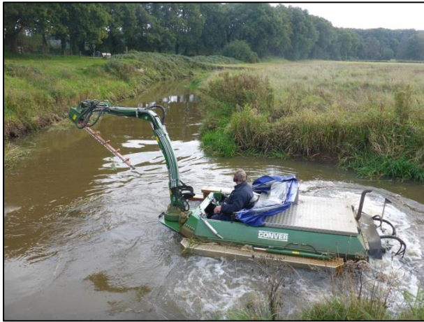
Afbeelding 7.8.a&b. Een deel van de Drentsche Aa wordt momenteel onderhouden met behulp van een maaiboot (a). Deze veroorzaakt met de voortstuwingschroeven veel opwerveling en verstoring van de waterbodem. Het waterschap onderzoekt nu of een lichte amfibische kraan (b) die rustig door het water kan rijden een mogelijk alternatief is die de waterbodem minder verstoort voor beektrajecten waar beheer met behulp van regulier materieel vanaf de kant niet mogelijk is.
