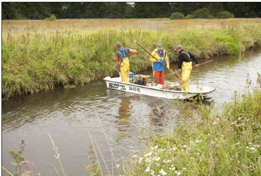
Afbeelding 4.4. Uitvoering van een KRW visstandbemonstering in de Drentsche Aa met behulp van een elektrovisapparaat in een boot. Met deze techniek worden vissen tijdelijk verdoofd en kunnen vervolgens uit het water geschept worden. Na het bepalen van de soort en meten van de lengte worden de vissen vervolgens weer levend teruggezet in de beek.
