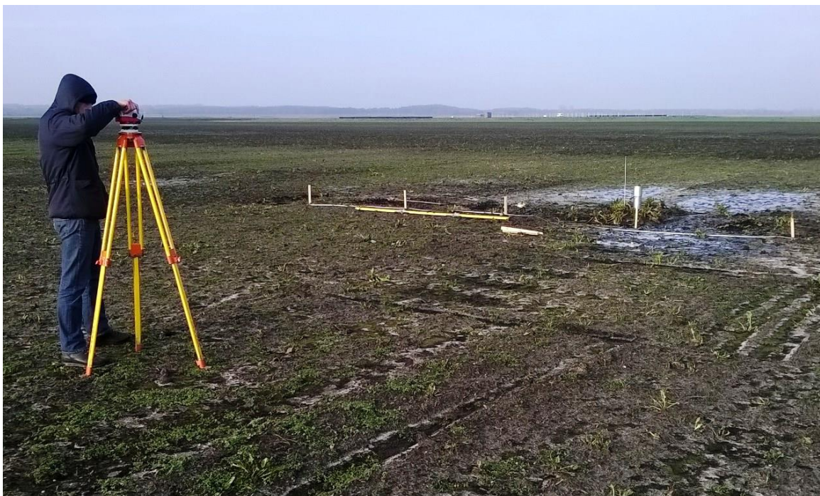
Figuur 3.6 Installatie en inmeten van vijf tijdelijke peilbuizen voor de bepaling van de opbolling tussen de drain op 22 januari 2015
