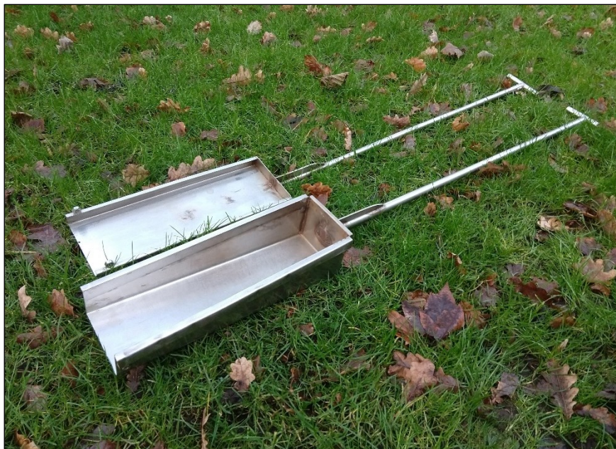
Figuur 3.3 De Vrijwitboor bestaat uit een kegervormig gedeelte en een losse achterwand waarmee de boor kan worden gesloten.
