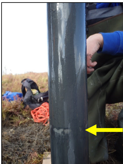
Figuur 3.2 Foto van een slibmonster uit de Klutenplas met witte markeerhorizont van kaolienklei die de grens markeert tussen de oorspronkelijke bodem van de Klutenplas en het nieuw afgezette slib na de aansluiting van de plas op de Dollard.
