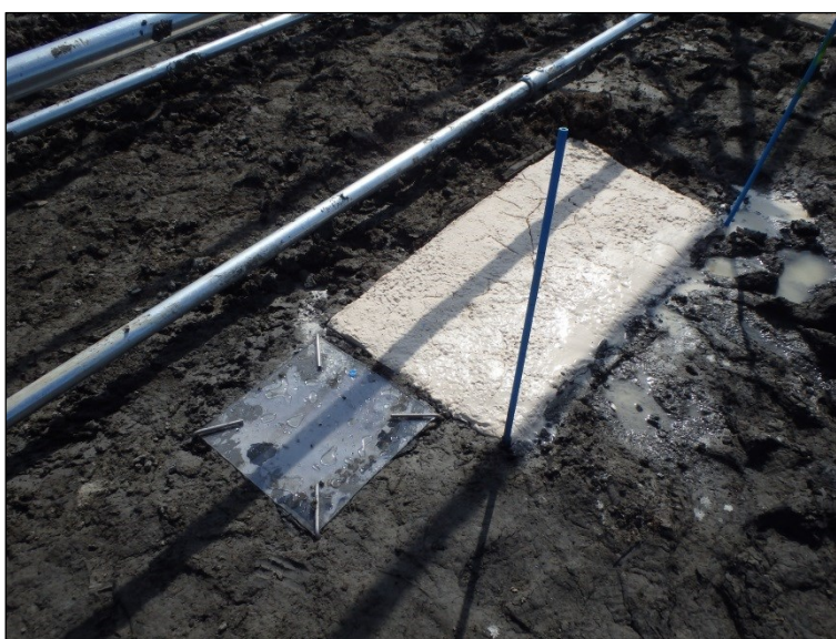
Figuur 2.3 Een veldje met opgebrachte kaolienklei als markeerhorizont op de bodem van de Klutenplas met ernaast een sedimentatieplaat. Langs de meetbrug zijn vijf paar van deze meetpunten aangelegd. Foto 19 april 2018.
