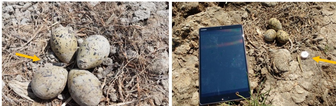
Foto 5 (links) Temperatuursensor in een Klutennest met vier eieren. Bij het pijltje is een klein zwart uitsteekseltje (de eigenlijke sensor) te zien in de nestkom. De temperatuur gegevens worden via het LoRa WAN netwerk weggezonden en elders opgeslagen. Foto 6 (rechts) Kluten nest met I button (pijltje) en tablet. Er zijn –naast LoRa WAN sensoren – ook I buttons gebruikt om nesttemperatuur te meten teneinde de twee technieken in de praktijk te kunnen vergelijken. De I button slaat temperatuurgegevens op. De tablet is benut om het nest effectief te vinden.
